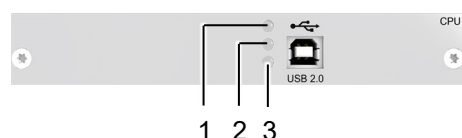
Fig. 41 Interface side add-on module USB 2.0 – Status LEDs L-/R474-BXE
